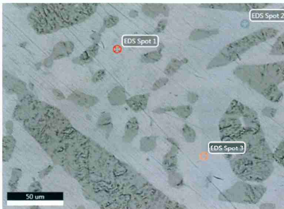
Figura 36 Imagem de Elétrons Retroespalhados (MEV)- Pontos escolhidos da fase matriz para análise de composição por EDS- Amostra B.
