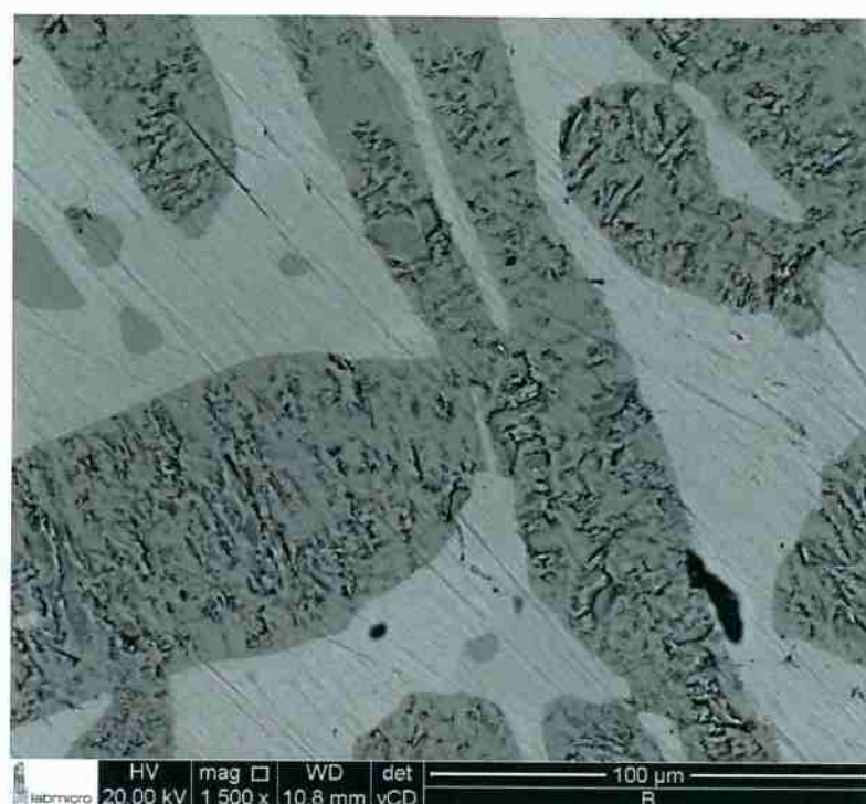
Figura 34 Imagem de Elétrons Retroespalhados (MEV) - Amostra B - 1500x - Tratamento Térmico 1100°C durante 80h.
