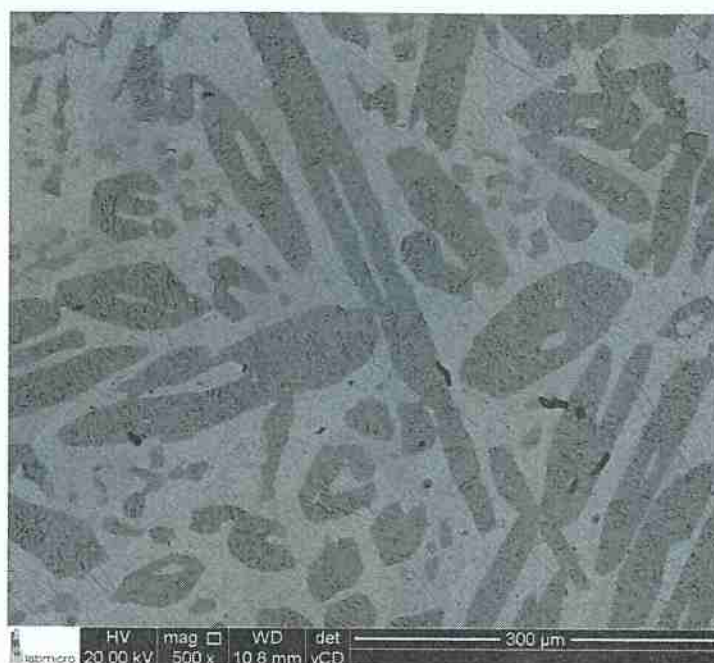
Figura 32 Imagem de Elétrons Retroespalhados (MEV) - Amostra B - 500x - Tratamento Térmico 1100°C durante 80h.
