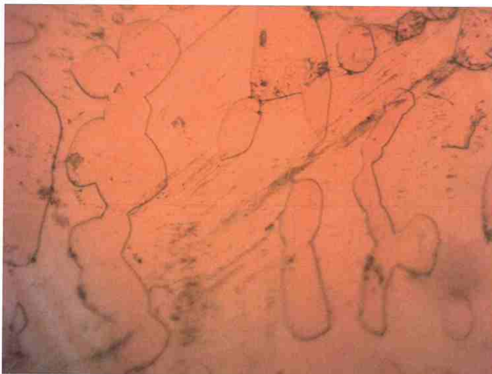
Figura 23 Micrografia Óptica - Amostra A - 1000x - Ataque Químico com reagente Kroll.
