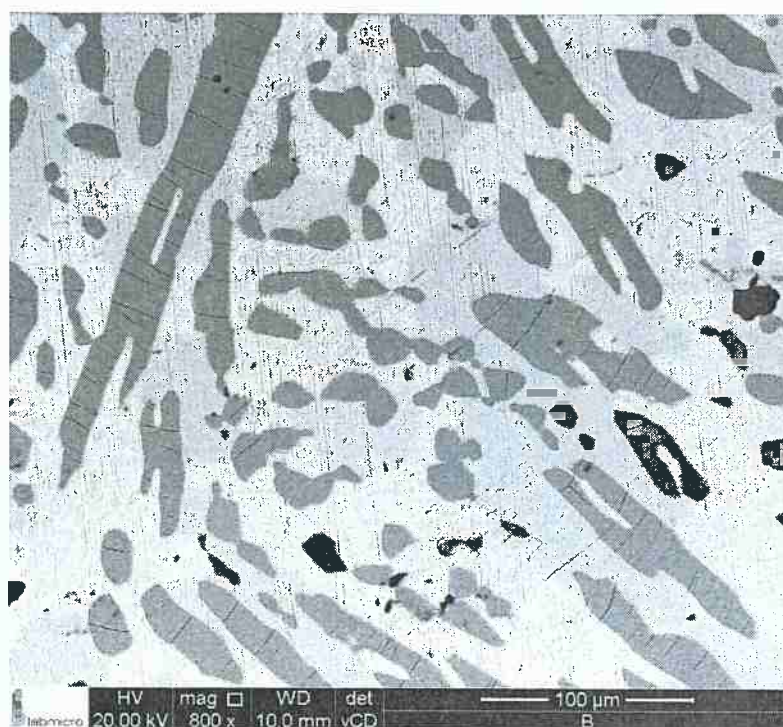
Figura 28 Imagem de Elétrons Retroespalhados (MEV) - Amostra A - 800x - Tratamento Térmico 1100°C durante 80h.
