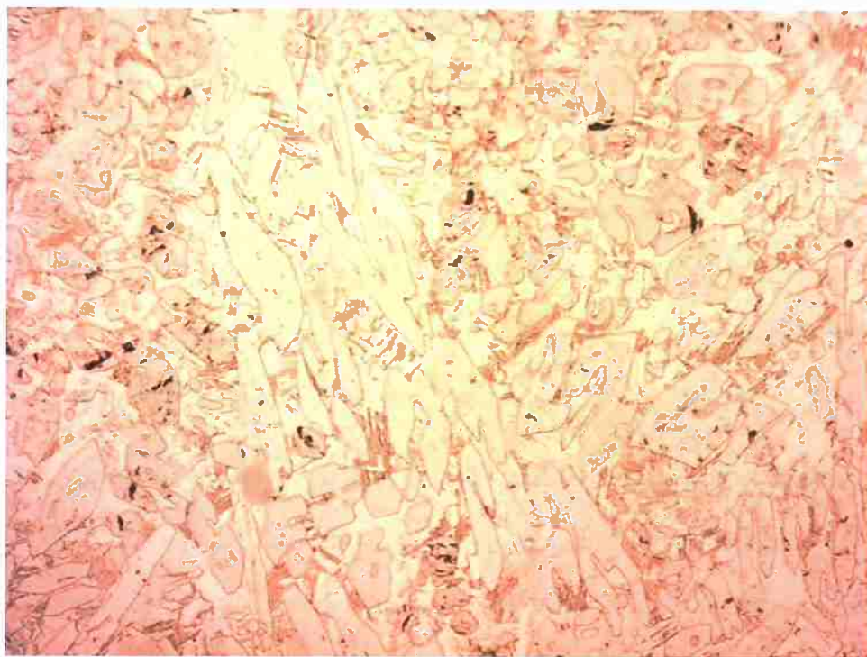
Figura 25 Micrografia Óptica - Amostra B - 100x- Ataque químico com reagente Kroll.
