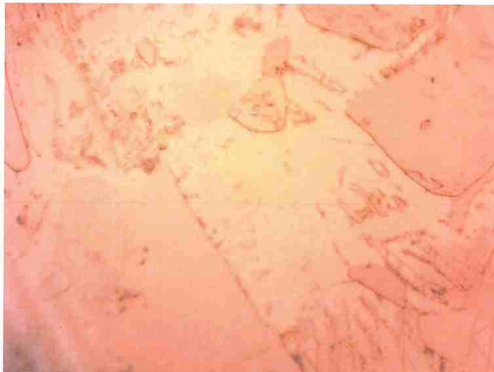
Figura 26 Micrografia Óptica - Amostra B - 1000x- Ataque químico com reagente Kroll.
