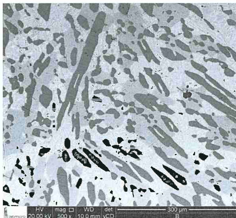
Figura 27 Imagem de Elétrons Retroespalhados (MEV) - Amostra A 500x- Tratamento Térmico 1100°C durante 80h.
