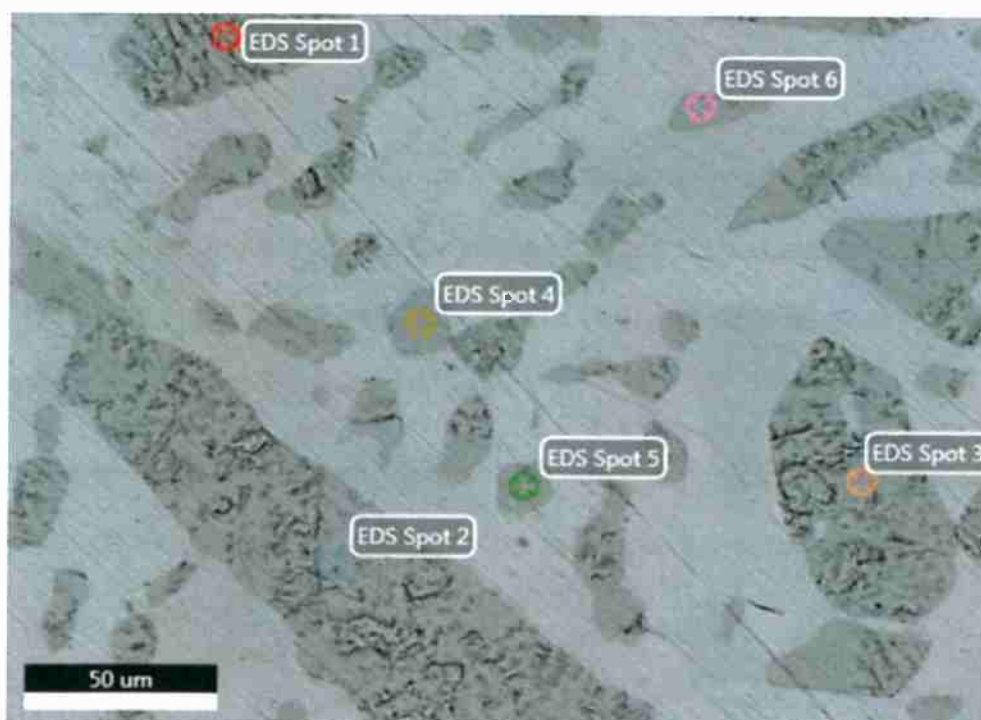
Figura 35 Imagem de Elétrons Retroespalhados (MEV)- Pontos para Análise por EDS Amostra B.
